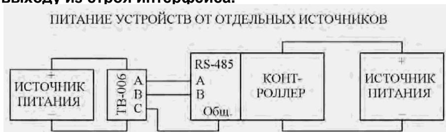
Функцию общего провода RS-485 может выполнять общий провод источника питания, к которому подключены эти устройства:
