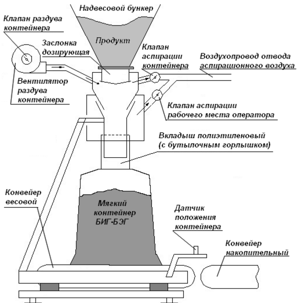
Рис. 7. Технологическая схема дозатора.
